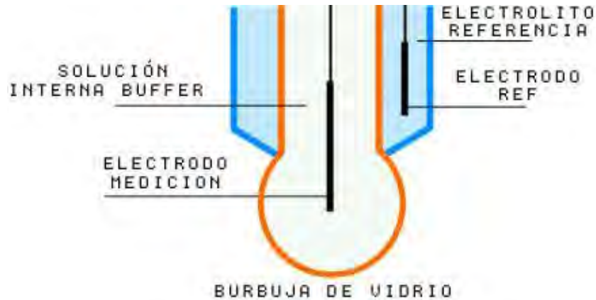
Figura 1. Configuración de un electrodo de pH (elaboración propia)
